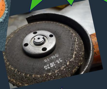
La **meuleuse** (Grinder) est un outil très pratique et polyvalent. On peut l'utiliser pour amincir le métal, ébavurer, enlever du matériel... et COUPER! Il s'agit de choisir le bon type de meule à installer sur l'outil. La **meule à tronçonner**, à droite, est un disque mince, qui ne doit être utilisé que pour **couper** les métaux (ne pas utiliser pour meuler). Vous verrez plus loin les autres fonctions de cet outil.
