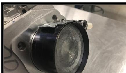
c) Compresser les segments à l'aide de l'outil et insérer l'ensemble piston bielle dans le bloc-moteur.
