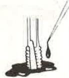
L'utilisation du lubrifiant approprié donne des filets plus lisses, plus propres et de formation plus exacte tout en prolongeant la durée de l'outil. On applique le lubrifiant aux tranchants pendant le filetage.
