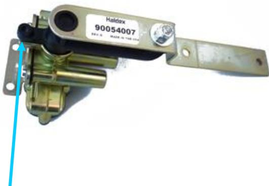
Emplacement de l'orifice de centrage de la soupape pour mettre la goupille.
