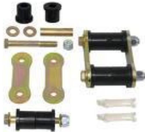
***Exemples d'ensembles de pièces de remplacement pour les jumelles (shackles) de lames de ressort avant.***
