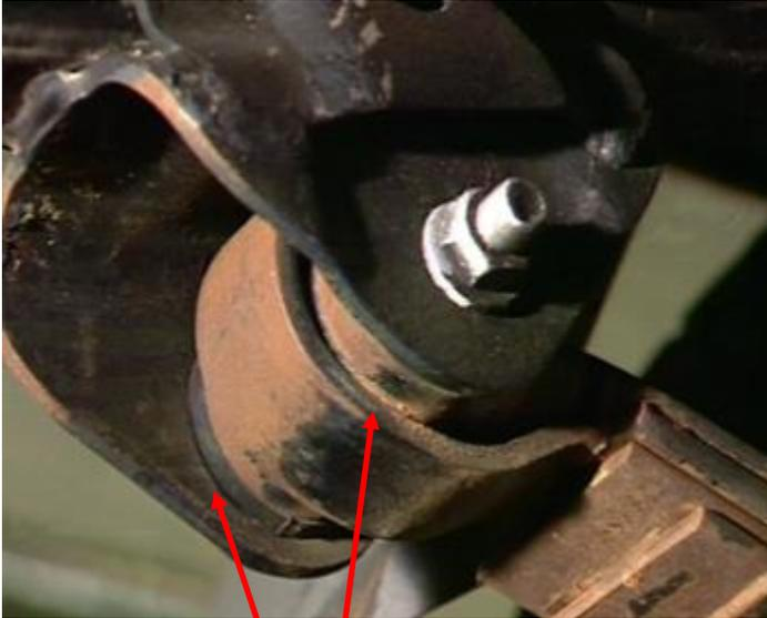
Vérifier à ces endroits pour vérifier qu'il n'y a pas eu de frottement entre le côté des lames et l'ancrage (bracket). Cela pourrait signifier que les U-bolts sont mal serrés ou bien que le véhicule nécessite un alignement. Vérifier le couple de serrage des U-bolts et vérifier l'alignement. Ce phénomène peut aussi se produire dans le cas d'un ensemble pin et bushing très déterioré.
