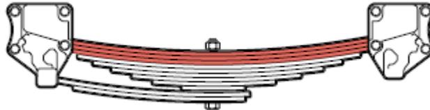
Ce type de suspension à lames multiples (spring pack), utilise un principe appelé ``self dampening``. Les lames amortissent en partie elles-mêmes l'oscillation causé par une compression et un relâchement. Quand la charge commence à s'appliquer, tour à tour les lames subiront une charge et subiront une flexion. Dans ce mouvement de flexion, les lames devront frotter les unes contre les autres, ce qui aura tendance à freiner l'effet de rebond des lames.
