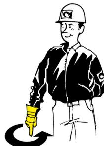
**Arrêt complet des mouvements de la grue**
